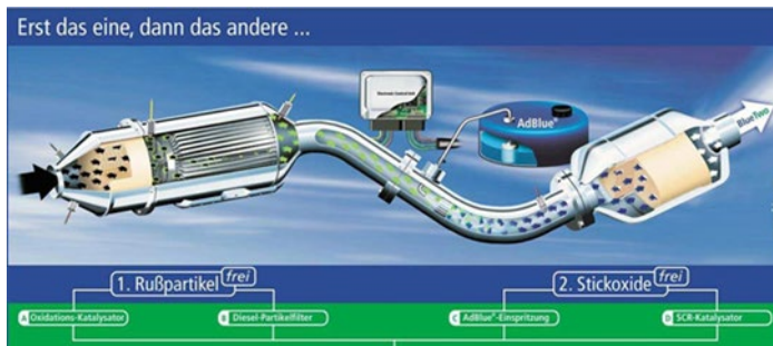
Abb.: SCR-Katalysator (selective catalytic reduction) = Selektive katalytische Reduktion von Stickoxiden
